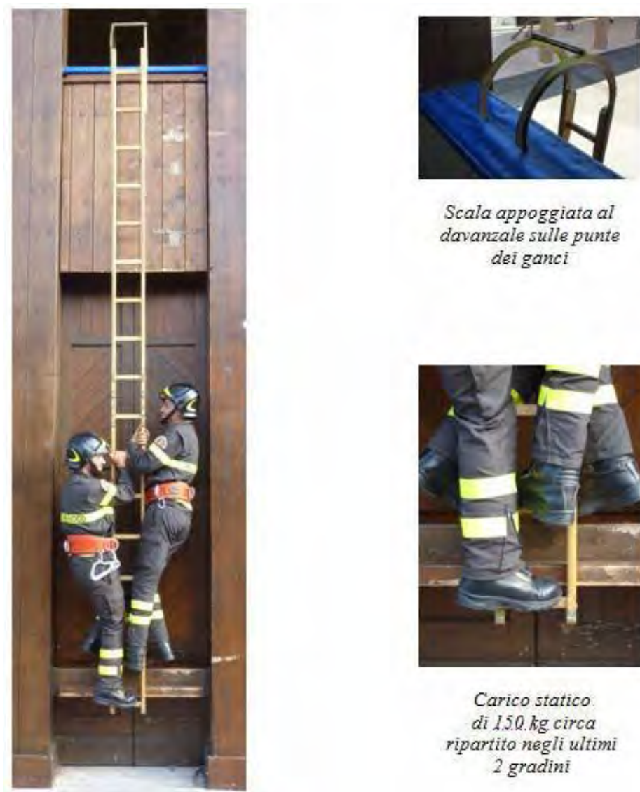
Figura 27: Posizionamento degli allievi sulla scala per eseguire il collaudo con carico statico di circa 150Kg. Particolari del posizionamento dei ganci sul davanzale e dei piedi degli allievi sui gradini della scala stessa.
