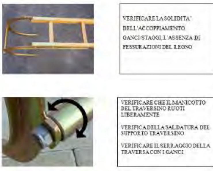
Figura 24: Controllo dei ganci della scala e del traversino in ferro posto tra i ganci stessi.
