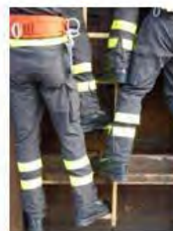
Carico statico di 300 kg circa ripartito negli ultimi 4 gradini
