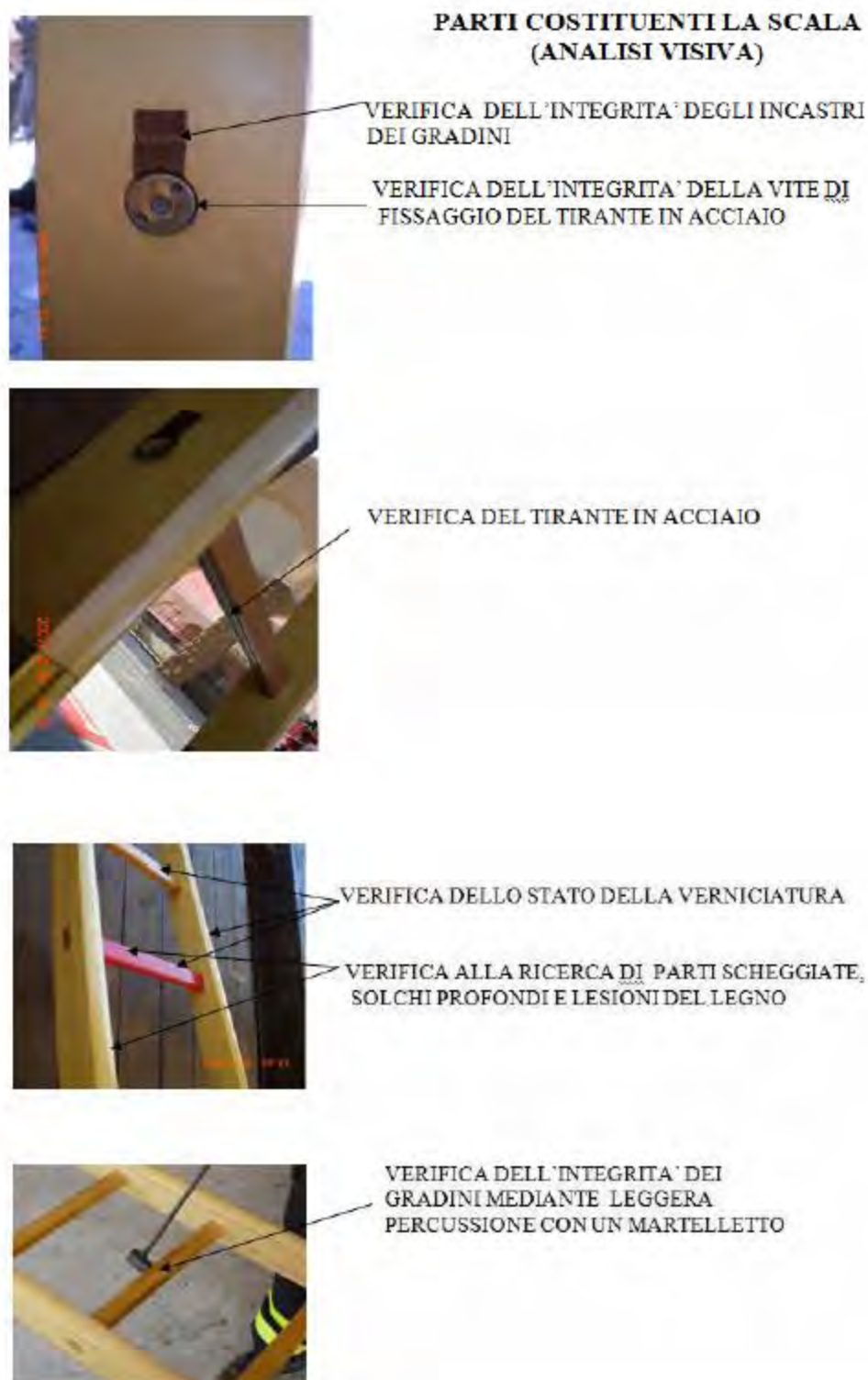
Figura 29: Particolari dei controlli su incastri, tirante d'acciaio, verniciatura e gradini della scala.
