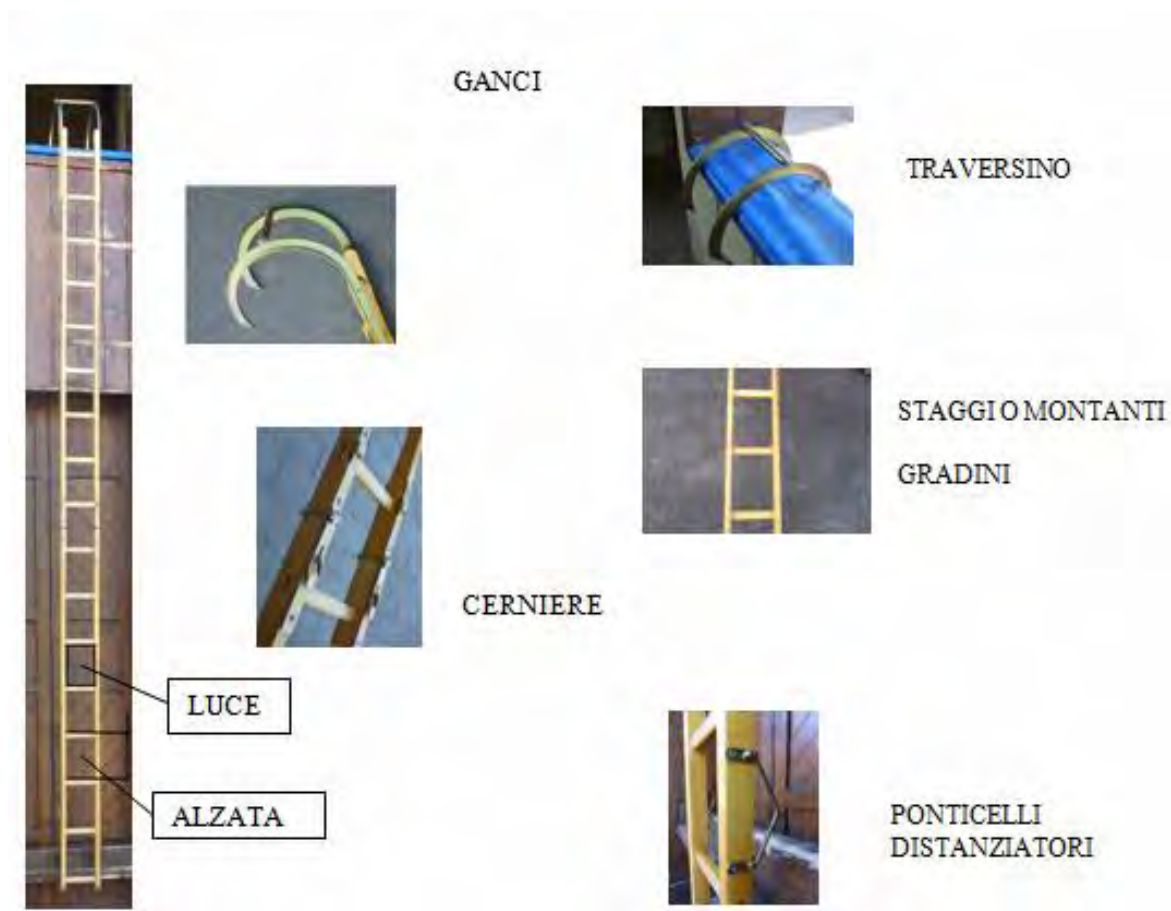
Figura 1: Foto della scala a ganci intera, a sinistra, e dei componenti con nomenclatura.
